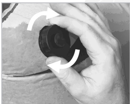
4. Sacar la pistola y tapar la válvula con el tapón. Asegurarse de que está bien cerrado.
